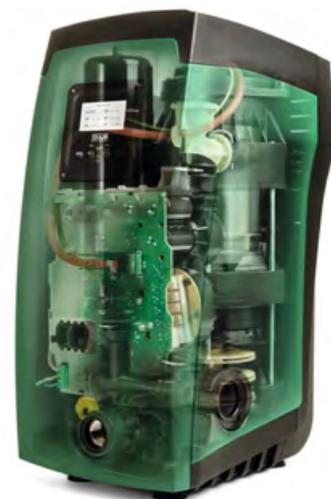
Система состоит из центробежного многоступенчатого электронасоса, охлаждаемого водой, а не воздухом, гарантирует меньший шум системы (не более 45 дБ) и возможность размещать устройство в не-вентилируемом помещении. Встроенный в систему расширительный бак объемом 2 л сертифицирован для питьевой воды и имеет гарантию 5 лет.
